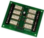
La controladora serial permite la comunicación entre la computadora de asistencia y el torniquete o los electroimanes. Sin esta controladora no será posible poder accionar o bloquear el acceso a sus clientes.
